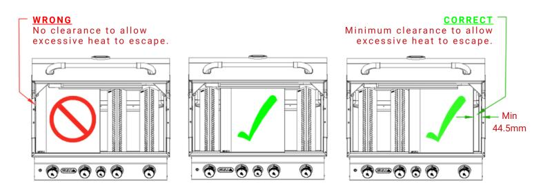
THERE SHOULD ALWAYS BE A MINIMUM GAP OF 44.5MM FROM THE GRIDDLE SIDES TO THE GRILL SIDES
